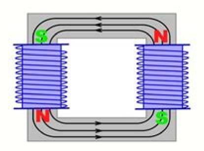
Das Magnetfeld und damit die Tragkraft dieses Magneten ist besonders stark, weil die magnetischen Feldlinien bzw. das Magnetfeld (fast) vollständig im geschlossenen Weicheisen gebündelt werden kann.
