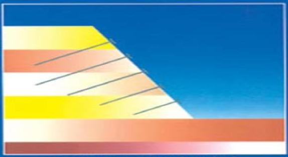
pour la conception, le calcul, l'exécution et le contrôle des soutènements réalisés par clouage des sols
