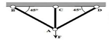
Ce système est hyperstatic En appliquant le Principe Statique pour traduire l'équi obtient :
