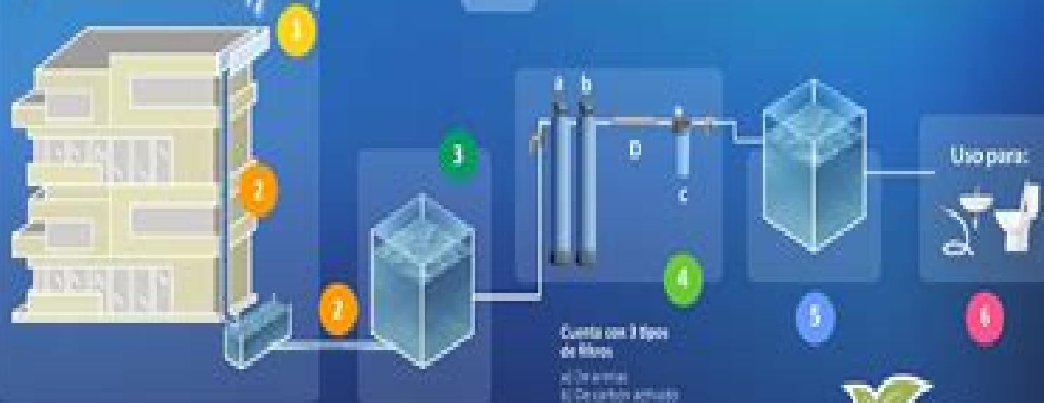
1. Captación de agua de lluvia en los techos de los edificios a través de conductos de lluvia
