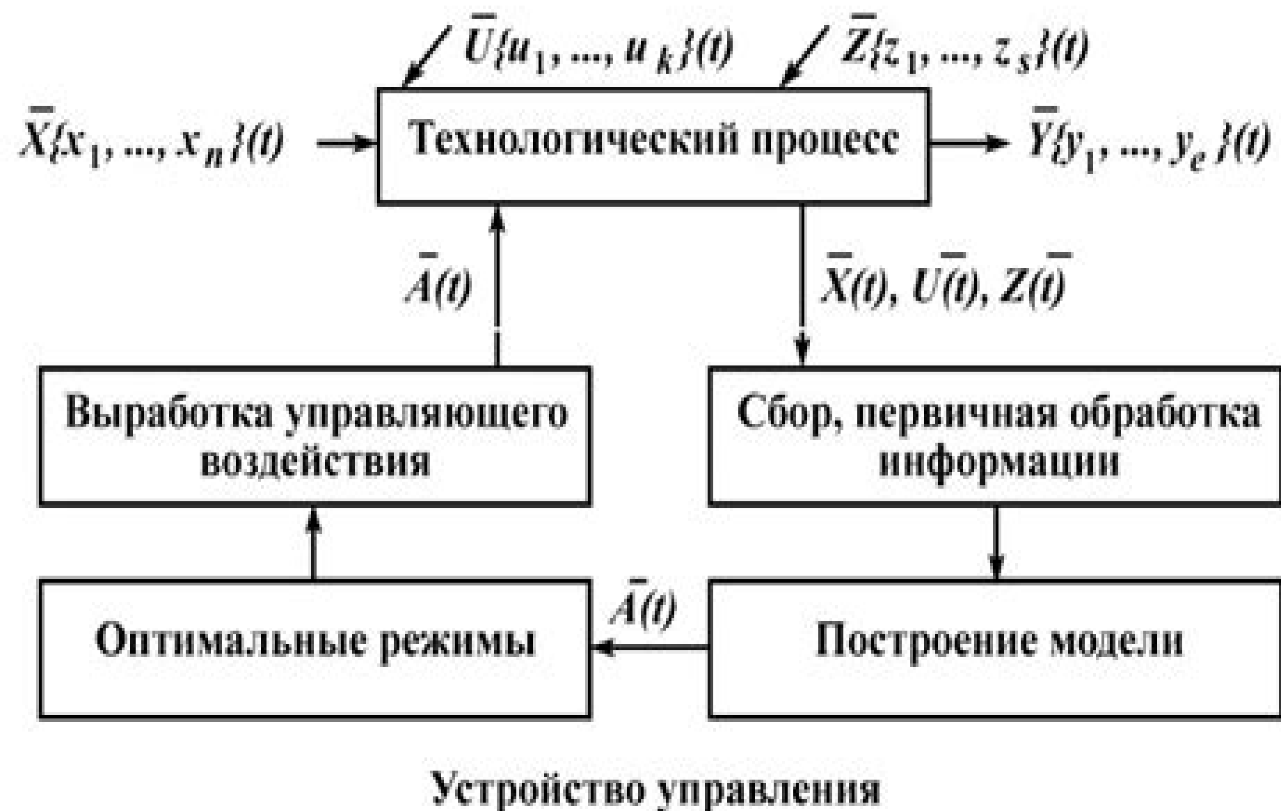
Рис. 1.5. Схема работы элемента системы добычи углеводородов на месторождении
